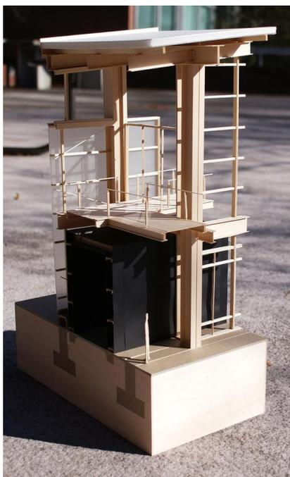
Imagen 4: Maqueta de detalle arquitectónico 1:50 que incluye cimentaciones y entorno.
